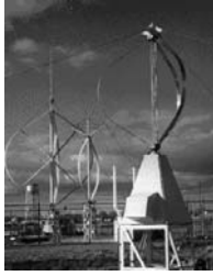
Exemplo da turbina idealizada por Darrieus
