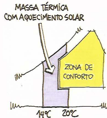
Zona de massa térmica e aquecimento solar
