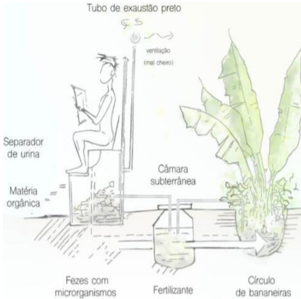
FIGURA 6- IMAGEM DO SISTEMA DE UM BANHEIRO SECO
