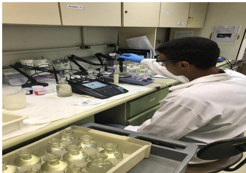
Figura 7: Foto da determinação de DBO: medição do Oxigênio Dissolvido.
