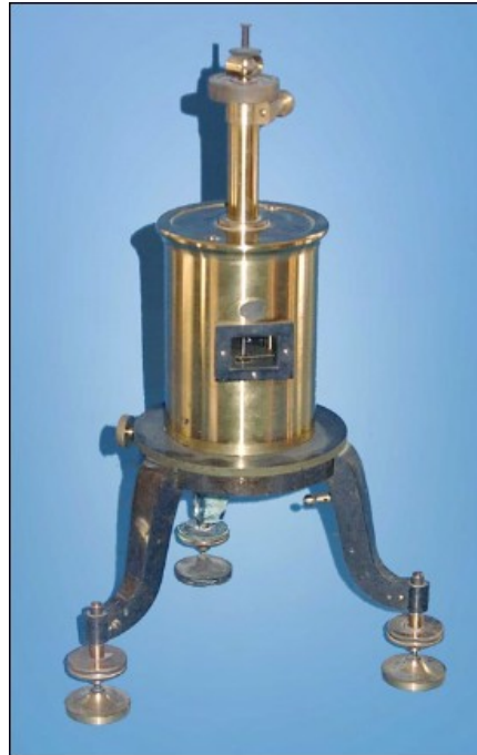
Figura 3 – Eletrômetro de quadrantes utilizado por Rutherford em seus experimentos.
