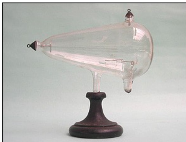
Figura 1 – Ampola de Crookes constituída com um ânodo e um cátodo construída em 1850.
