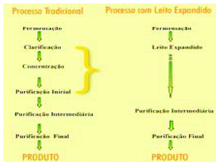
Figura 4: Processo tradicional e processo de leite Expandido para a purificação de proteínas;
