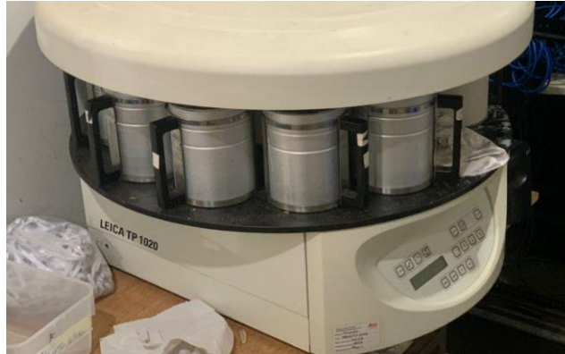
Figura 4: Processador automático de carrossel (PLATAFORMA NACIONAL DE INFRAESTRUTURA DE PESQUISA, 2022).
